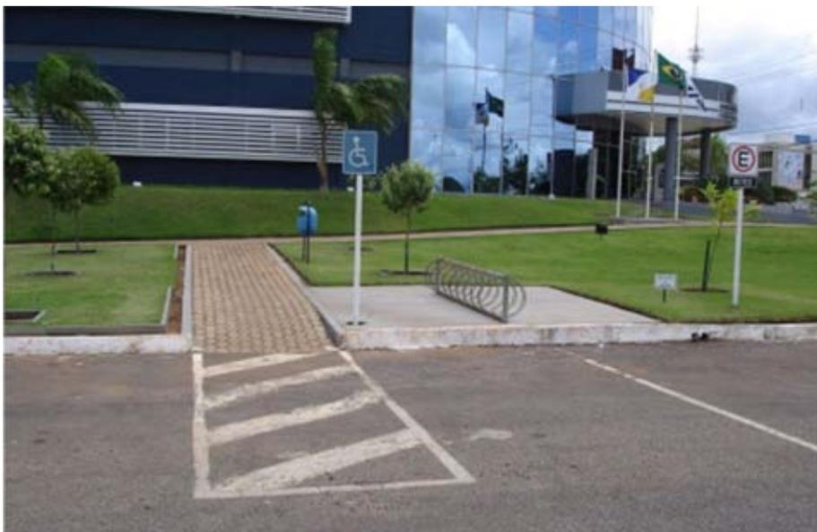
Foto 14: Exemplo de vaga demarcada para deficiente físico, com devida área de acesso lateral e guia rebaixada.
